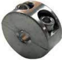
Klemmring aus zwei Halbschalen • nach erfolgter Seilbelastung muss der Klemmring nachgezogen werden • Aisi 316 • Niro.
