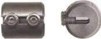
Schlaufenbildung mit Zylinderklemmen • ca. 50 % der Seilmindestbruchlast • nach erfolgter Seilbelastung muss die Zylinderklemme nachgezogen werden • Aisi 316 • Niro.
