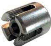
Kreuzklemme um Drahtseile im 90° Winkel zu fixieren • nach erfolgter Seilbelastung muss die Schraube nachgezogen werden • Aisi 316 • Niro.
